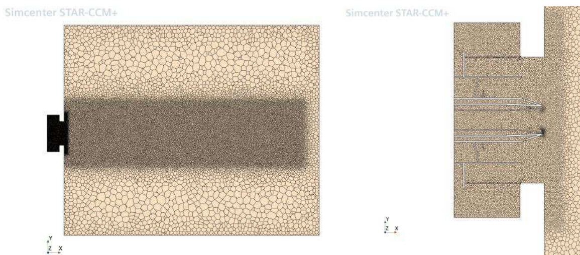
Рисунок 4.7 – Визуализация расчетной сетки в модуле «Automated Mesh»
