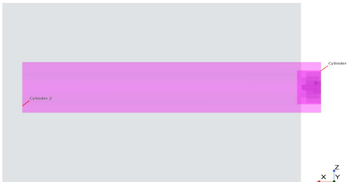
Рисунок 4.6 – Распределение цилиндрических расчетных зон в смоделированной камере сгорания: Cylinder 1 – зона горелочного устройства, Cylinder 2 – зона наиболее высоких скоростей и температур
