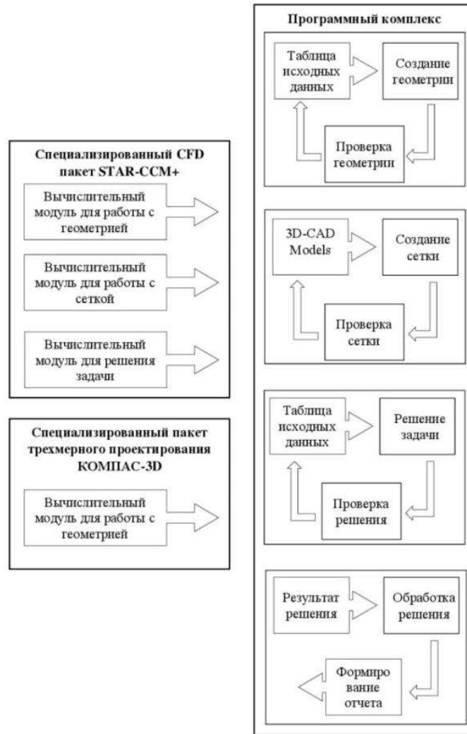
Рисунок 3.1 – Структурное содержание и процессы элементов комплекса
