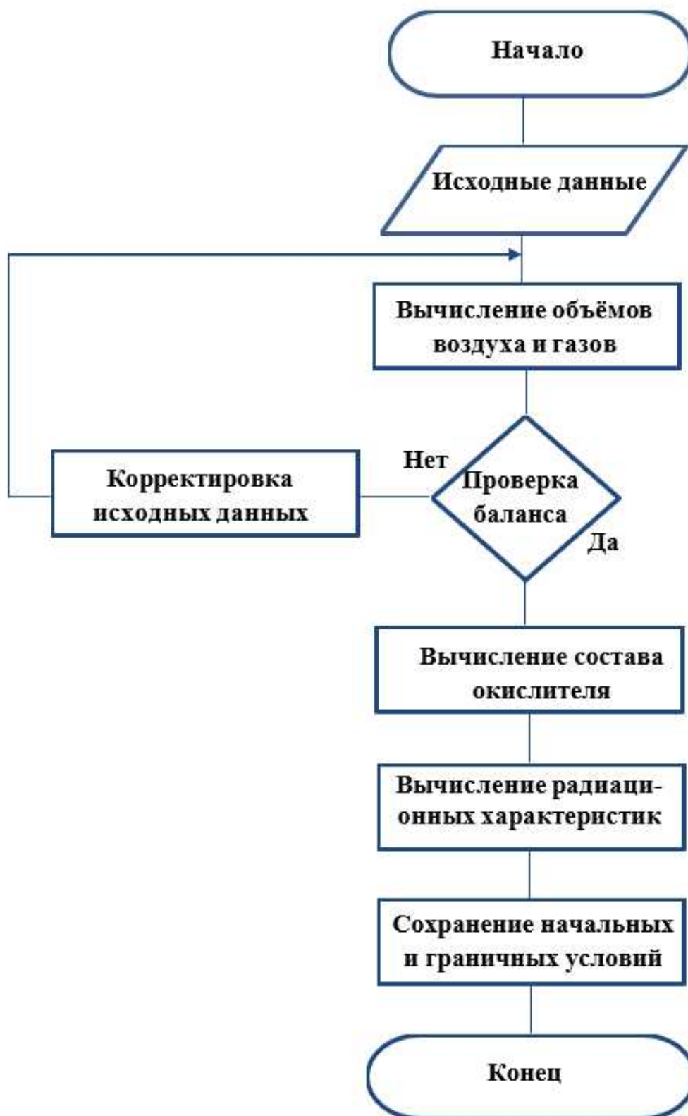
Рисунок 2.7 – Алгоритм уточнения радиационных характеристик
