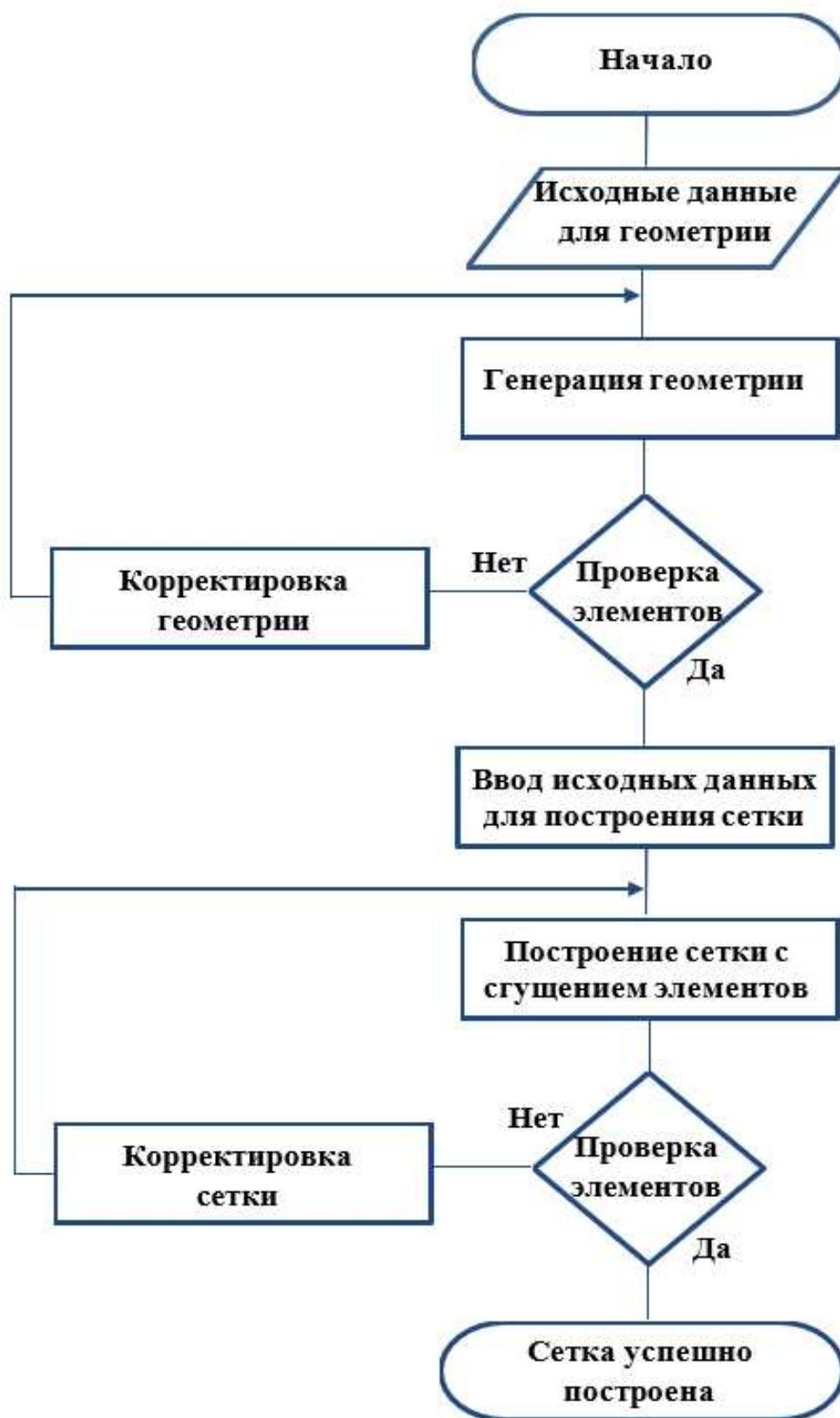
Рисунок 2.8 – Алгоритм задания густоты расчетной сетки
