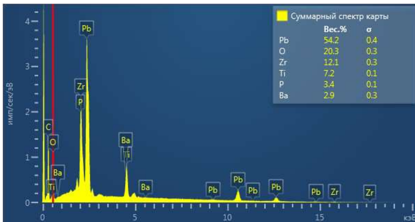
Рисунок 4.11 — Рентгенофлуоресцентный спектр и результаты количественного анализа элементного состава образца прессованного композита при увеличении \times 2000
