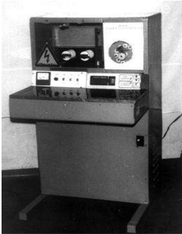
Рисунок 4.22 – Высоковольтная измерительная установка УВИР–1
