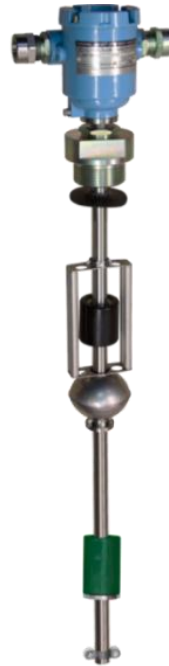
Рисунок 1.2 - Уровнемер-плотномер ПМП-201 НПП «Сенсор» с поплавками уровня, плотности и раздела фаз.
