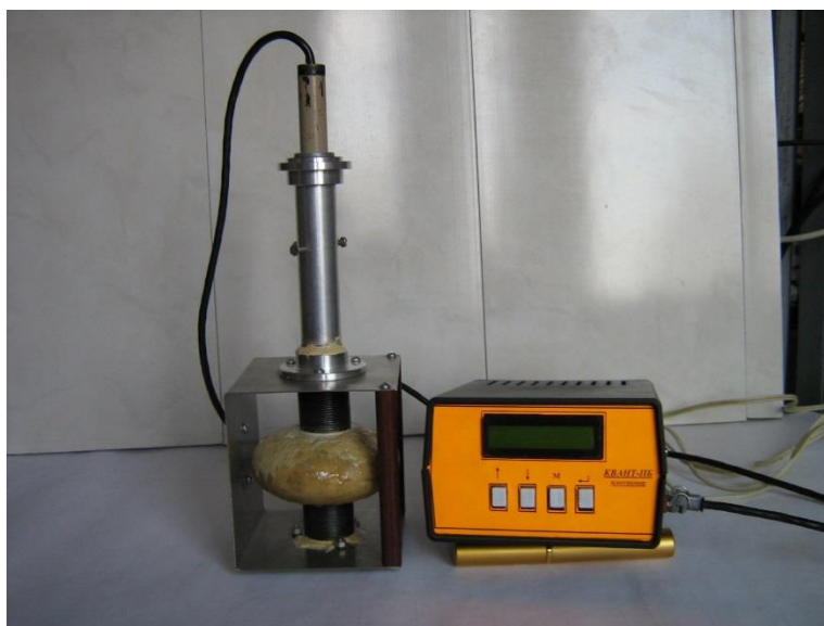
Рисунок 3.12 - Поплавковый датчик плотности в составе ВОИИС для определения плотности пожароопасных жидкостей
