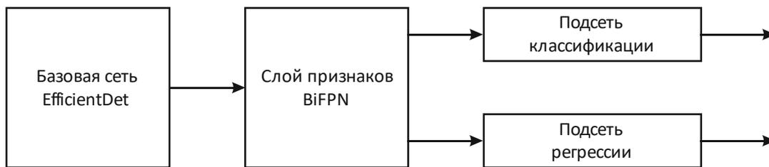
Рисунок 16 – Архитектура сверточной нейронной сети EfficientDet
