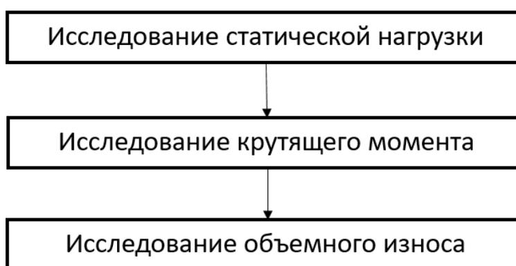
Рисунок 6 – Методика испытаний основных характеристик пары трения эндопротезов тазобедренного сустава
