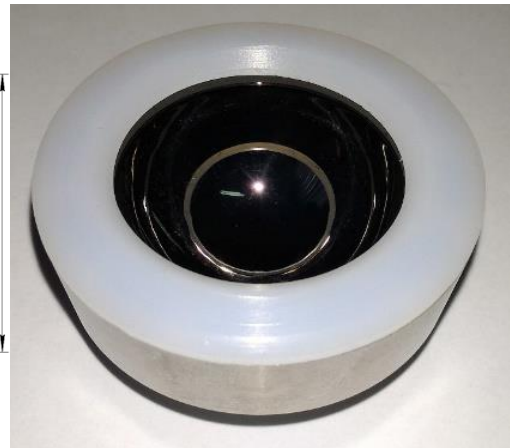
Рисунок 65 – Эскиз и внешний вид вкладыша с углеродной вставкой: 1 – титановый адаптер; 2 – вставка из монолитного углеситалла; 3 – полиэтиленовый буртик
