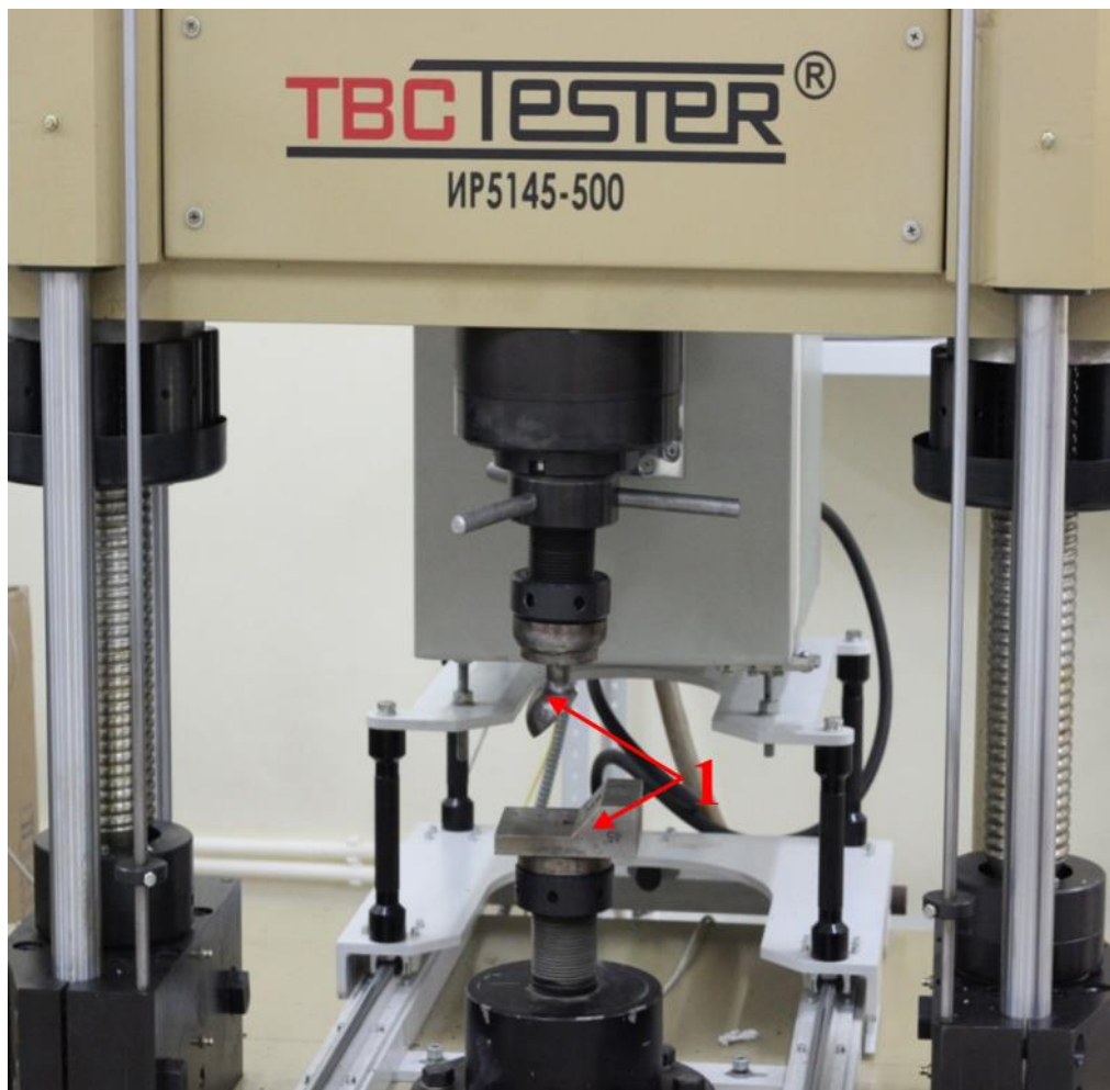
Рисунок 66 – Внешний вид установки для определения максимальной статической нагрузки пары трения из углеситалла с установленной оснасткой: 1 – оснастка для испытания пары трения
