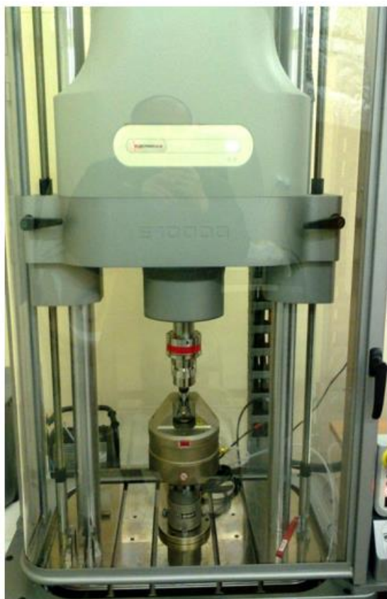
Рисунок 71 – Установка ElectropulsE10000, предназначенная для определения крутящего момента пары трения тазобедренного сустава: 1 – пара трения из углеситалла; 2 – оснастка для фиксации головки и вкладыша эндопротеза
