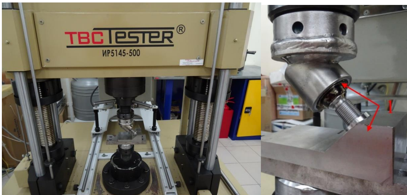
Рисунок 68 – Установка для испытания на статическую нагрузку пары трения с вмонтированной оснасткой: 1 – оснастка с установленной парой трения из углеситалла
